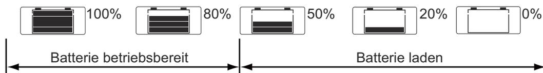
**Startfähigkeit der Batterie testen (nur bei Gerätetypen Acctiva Easy)**
